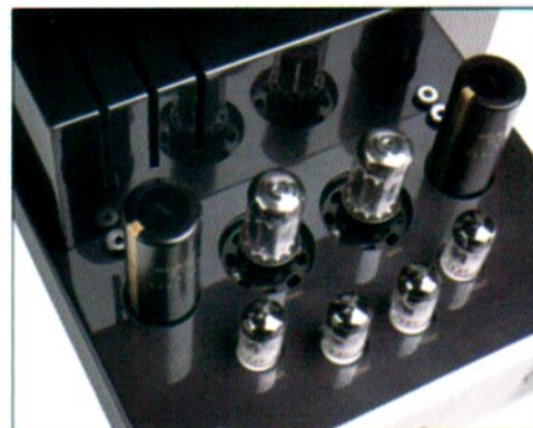
Interessantes Röhrenensemble: Gleich zwei Gleichrichterröhren besorgen die Anodenspannungen für die glimmenden Verstärkerbauelemente
